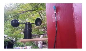
Figure 3: Anemometer and DHT11 Sensor
