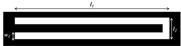
Figure 2: Dimension of DMS U-Shape,  $l_1=16.2$  mm,  $l_2=1.1$  mm,  $W_1=0.35$  mm
