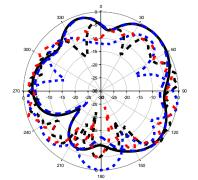
(d) Elevation radiation pattern of H-plane at 5.2 GHz
