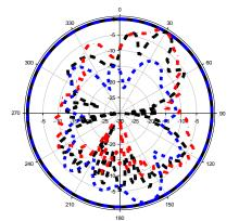
(d) Azimuth radiation pattern of H-plane at 5.2 GHz
